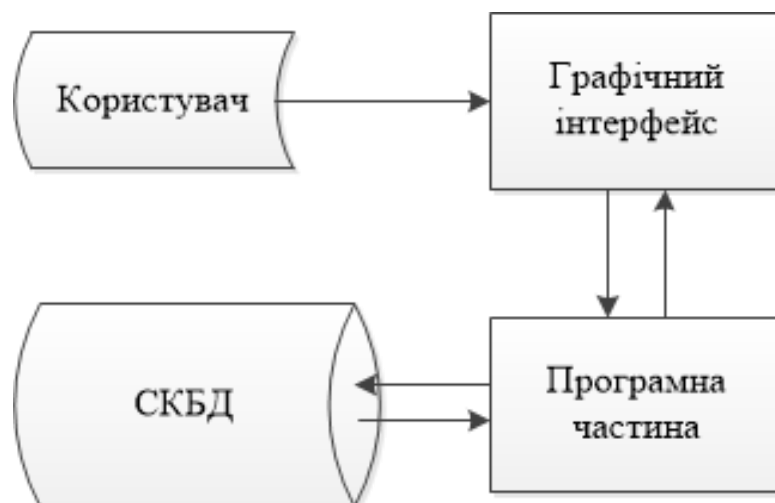
Рисунок 3.1 – Схема взаємодії основних модулів програмного забезпечення електронного щоденника здобувача освіти
