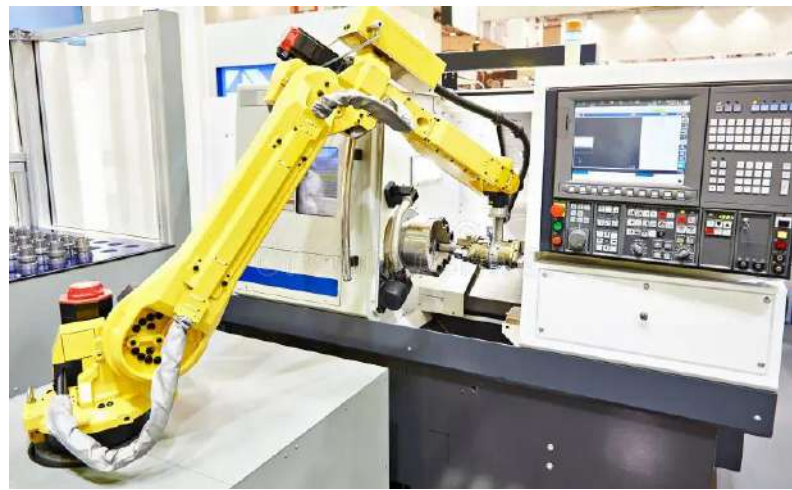
Рисунок 3.2 – Система автоматичної загрузки деталей [15]
