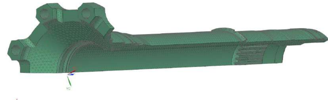
Рисунок 4.2 – Модель деталі розбита на сітку кінцевих елементів
