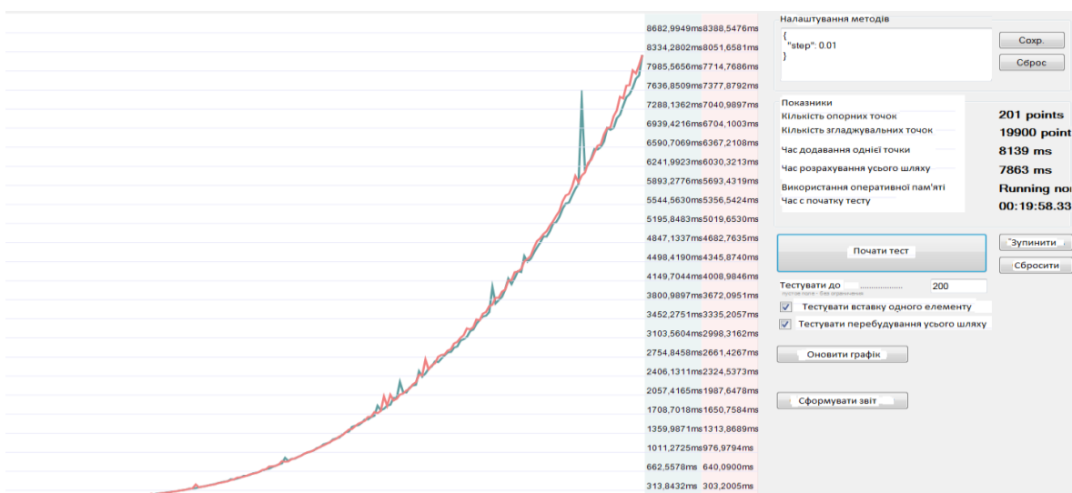
Рисунок 1.19 – Графік залежності часу розрахунку многочлена Лагранжа від кількості точок кривої
