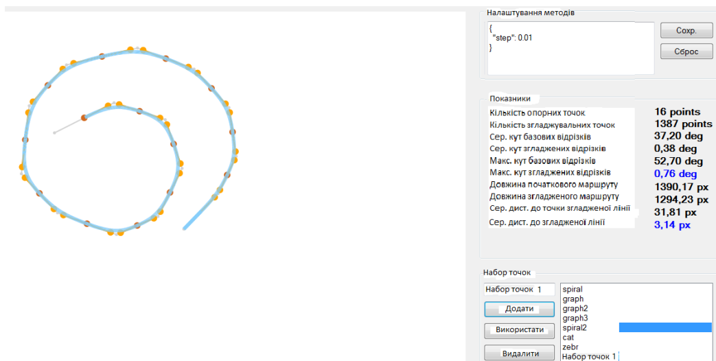
Рисунок 1.12 – Зразок роботи методу кривих Безьє з опорними точками в центрі базових відрізків на шаблоні spiral
