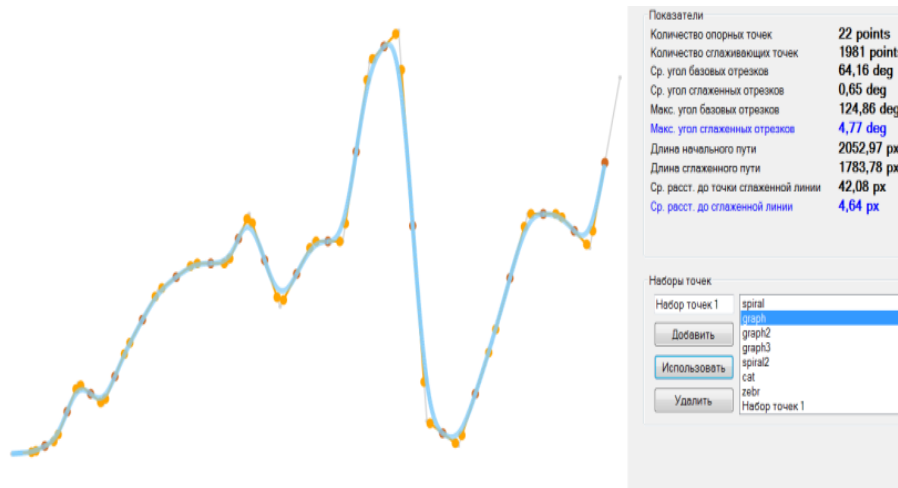
Рисунок 1.11 – Зразок роботи методу кривих Безьє з опорними точками в центрі базових відрізків на шаблоні graph
