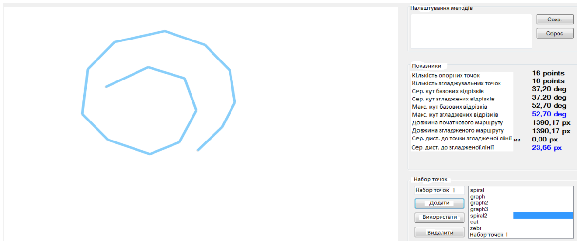
Рисунок 1.21 – Зразок роботи кусково-лінійної інтерполяції на шаблоні spiral
