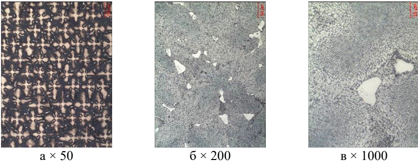
Рисунок 2 – Мікроструктура зразків зі сплаву ЗМІ-М5, що отримані методом високошвидкісної спрямованої кристалізації до термообробки.
