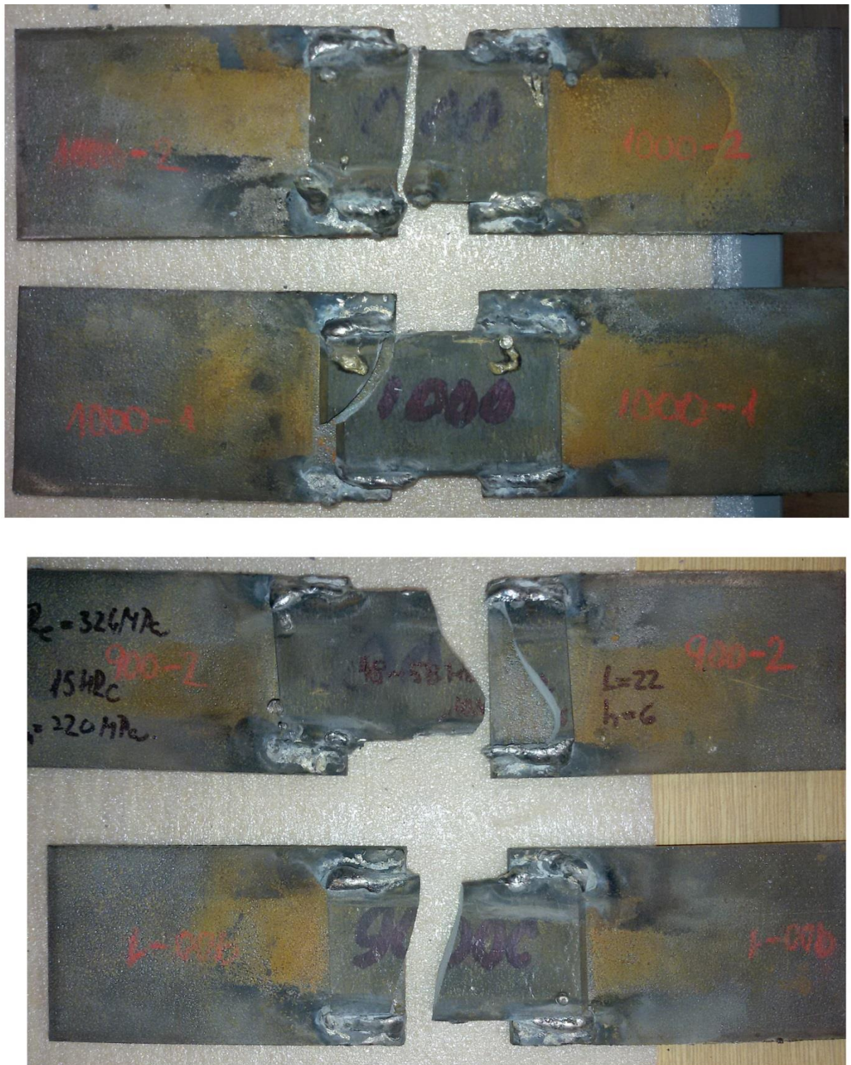
Рисунок 5.5 – Зруйновані технологічні проби
