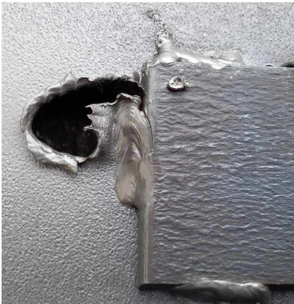
Рисунок 5.19 – Бронь, яку відновлено пластиною з ізотермічною обробкою станом на 01.11.2019. Вигляд зі сторони зварних з'єднань
