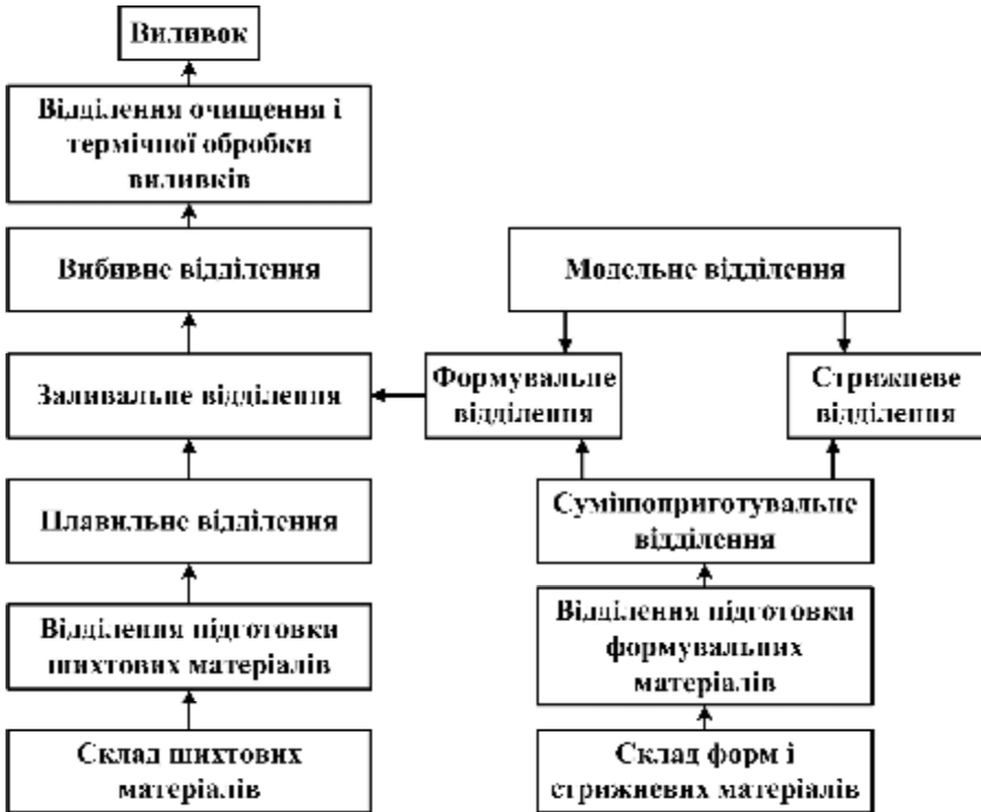
Рисунок 1.1 – Структура ливарного цеху і технологічного виробництва виливків
