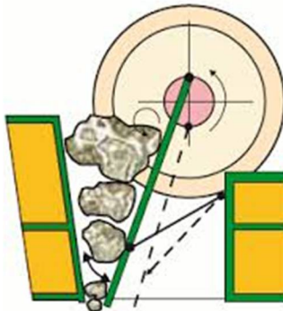
Рисунок 2.1 – Схема роботи щоківі дробарки
