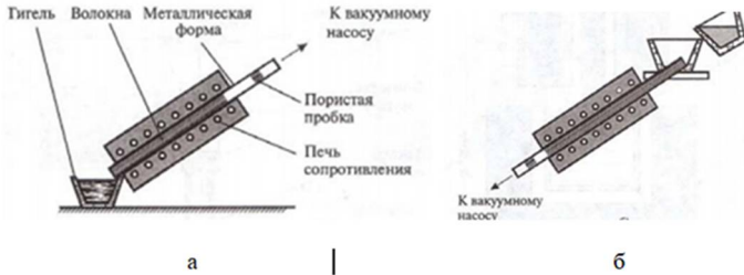
Рисунок 17.1 – Схема виробництва МКМ примусовим просочуванням
