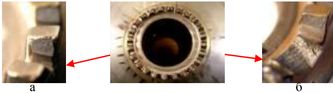
а – контактне зношування зуба; б – вирид зуба;
