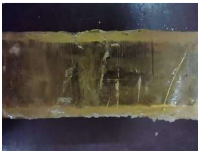
Рисунок 3.1 – Тріщини на поверхні зразка
