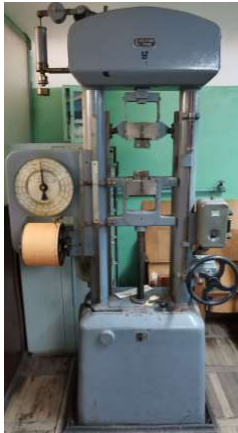
Рисунок 2.2 - Розривна машина, що використовувалася для дослідження міцності
