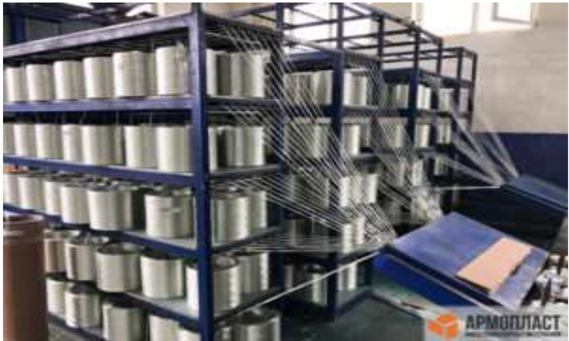
Рисунок 1.15 – Процес подачі ниток на лінію [20]
