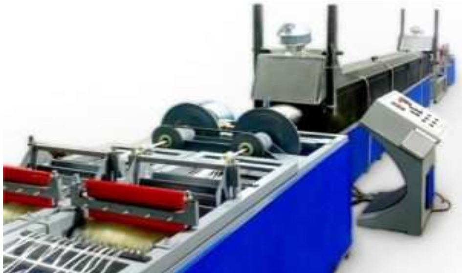
Рисунок 1.16 – Процес намотування ровінгу на композитну арматуру [20]
