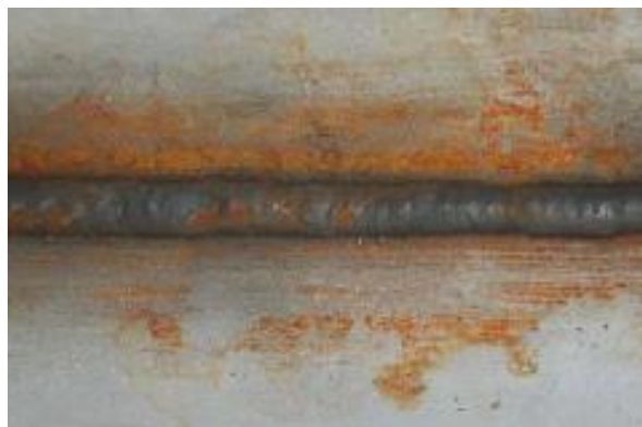
Рисунок 3.15 – Забруднення, спричинене забрудненням залізом від щітки з м'якої сталі [3]
