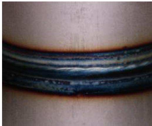
Рисунок 3.13 – Зварний шов із залишками зварювального оксиду [3]
