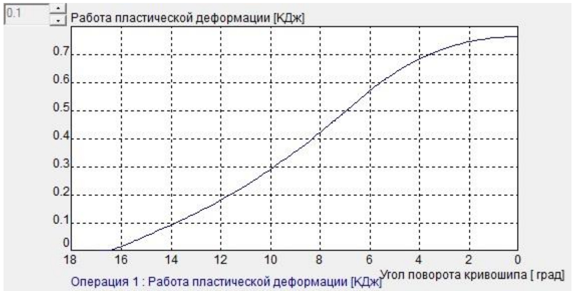
Рисунок 3.26 - Графік залежності роботи процесу видавлювання заготовки із фаскою на торцевій поверхні від кута повороту кривошипа
