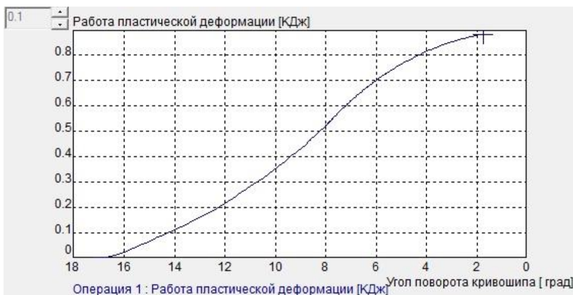
Рисунок 3.13 - Графік залежності роботи деформації від кута повороту кривошипа пресу
