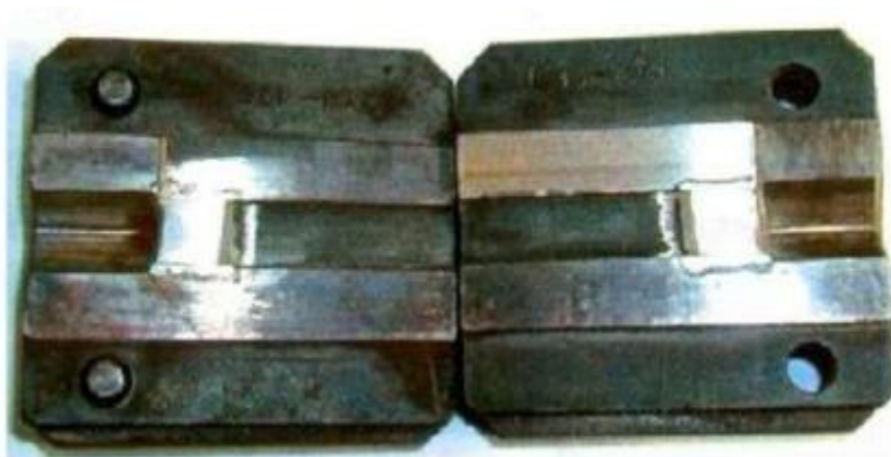
Рисунок 2.3 – розємна матриця для видавлювання заготовок компресорних лопаток
