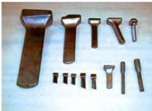
Рисунок 2.2 - Заготовки лопаток компресора, отримані видавлюванням
