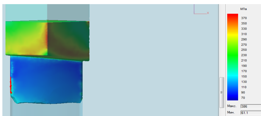
Рисунок 3.15 – Результат видавлювання заготовки з плоским торцем(максимальний опір деформації)
