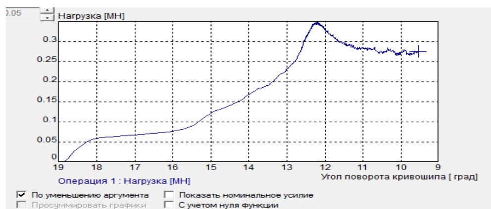
Рисунок 3.33 – Графік зусилля деформування в залежності від кута повороту кривошипа
