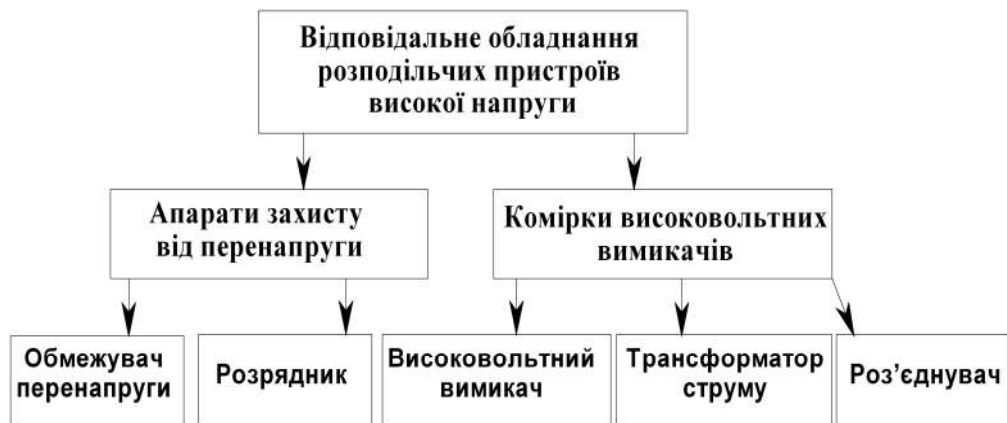
Рисунок 2.1 – Структурна схема відповідального обладнання РПВН
