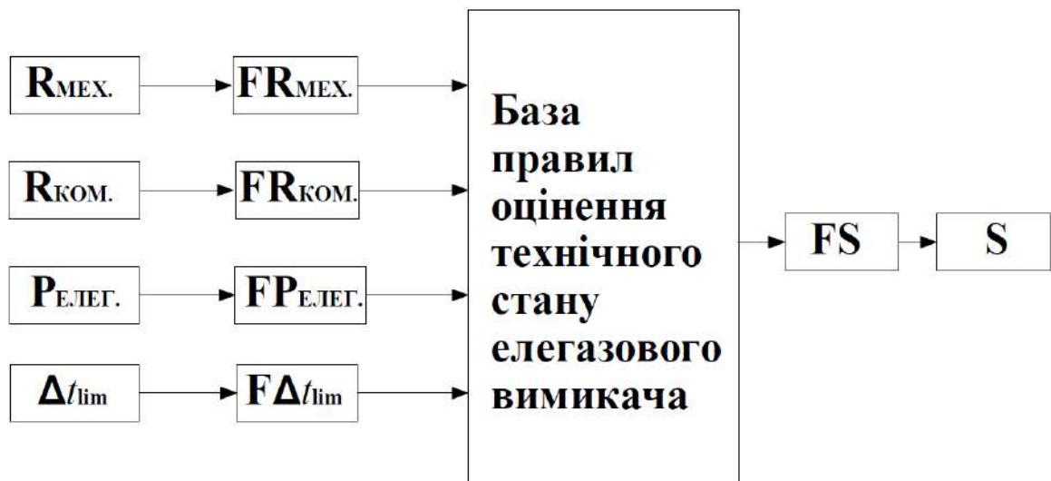
Рисунок 4.6 – Структурна схема нечіткої моделі для оцінення ТС елегазового вимикача
