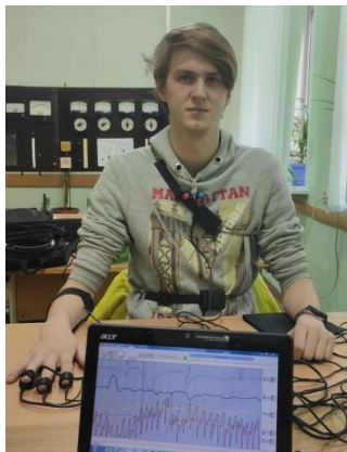
Рисунок 2.9 – Вимірювання фізіологічних параметрів за допомогою поліграфа "Бар'єр" (ауд. 115, каф. МІНЕ)
