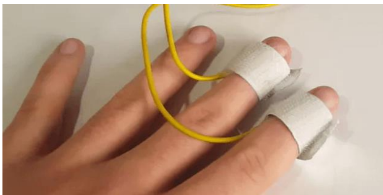
Рисунок 3.8 – Приклад застосування датчика шкірно-гальванічної реакції
