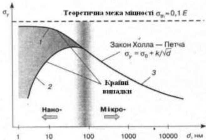
Рисунок 2.11 – Залежність межі текучості \sigma_y від розміру зерна d у матеріалі
