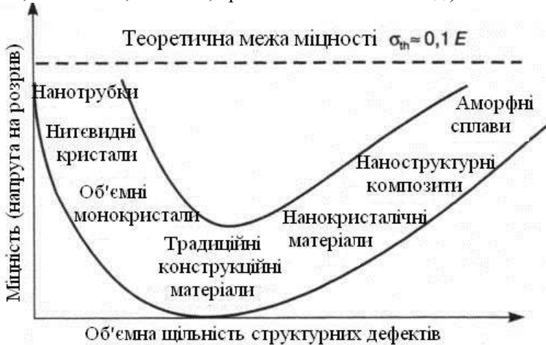
Рисунок 2.7 – Схематична залежність міцності матеріалів від концентрації атомарних дефектів, що демонструє два принципово можливих шляхи поліпшення міцностних характеристик за рахунок зменшення і за рахунок збільшення кількості дефектів структури
