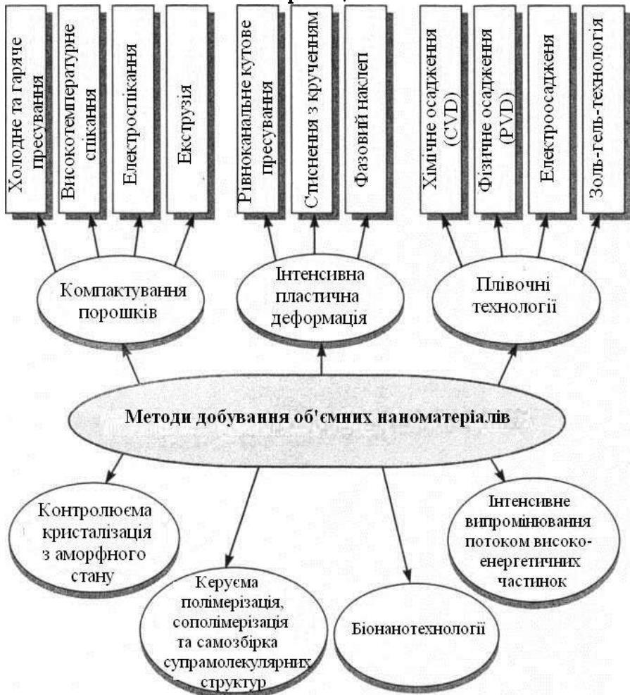
Рисунок 2.4 – Основні методи виробництва об'ємних наноматеріалів
