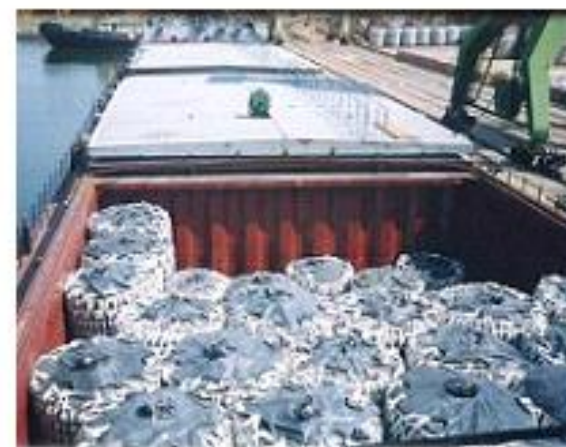
Рисунок А.4 – Технологія перевантаження вугілля з контейнерів МК-14-10 ПП у трюми судна в річковому порту
