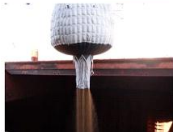
Рисунок А.4 – Технологія перевантаження вугілля з контейнерів МК-14-10 ПП у трюми судна в річковому порту
