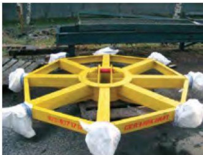
Рисунок 2.2 – Траверса для перевантаження м'яких контейнерів МК-14-10
