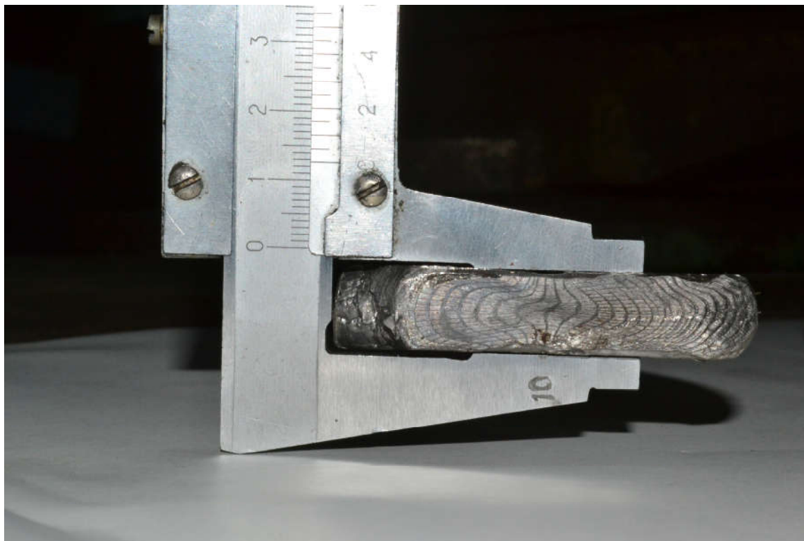
Рис. 3.10 Розподіл течії металу при вільному осаджуванні. Ступінь деформації 50%. Зусилля = 34.5тн.
