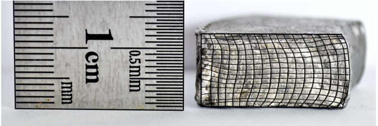
Рис. 3.11 – Розподіл течії металу при осаджуванні з зовнішнім підпором. Ступінь деформації 50%. Зусилля = 33тн.
