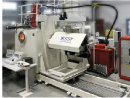
Рисунок 5.4 - Установка для перфорування електронним променем фірми Steigerwald з багатокоординатним ЧПК(високошвидкісний електронно-променевий перфоратор) [16].
