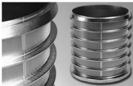
Рисунок 5.5 - Фільтр з нержавіючої сталі завтовшки 1,5 мм з 350000 отворами діаметром 0,1 мм, отриманими електронно-променевим свердлінням
