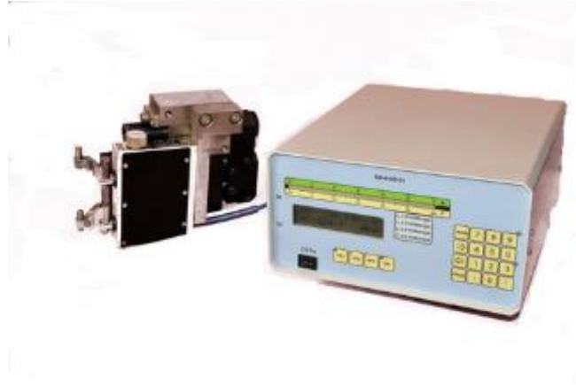
Рисунок 3.3 - БВ-4305. Прилад для контролю деталей з безперервною поверхнею
