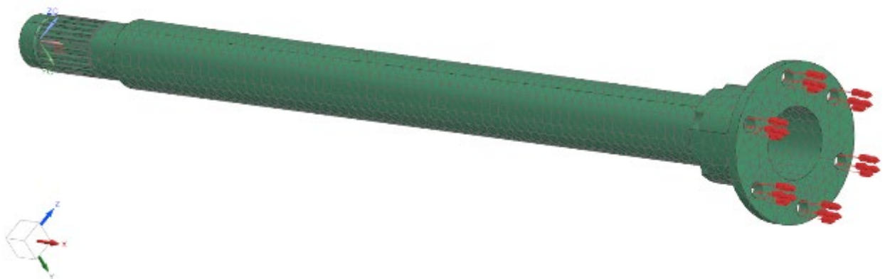
Рисунок 4.3 – Схема прикладення обмежень та навантажень
