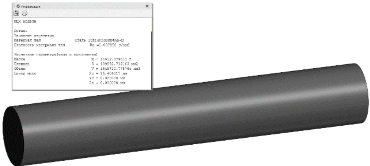
Рисунок 1.3 – Тривимірна модель заготовки, що отримана з круглого прокату
