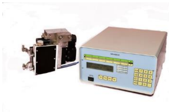
Рисунок 3.4 - БВ-4306. Прилад для контролю деталей з переривчастою поверхнею
