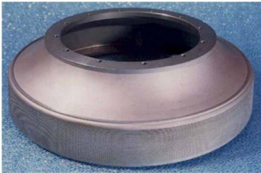
Рисунок 5.11 - Отвори, отримані лазерним свердлінням за технологією Fire, - On - The Fly
