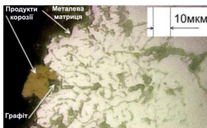
Рисунок 6 - Початкова стадія проникнення корозії в поверхню.
