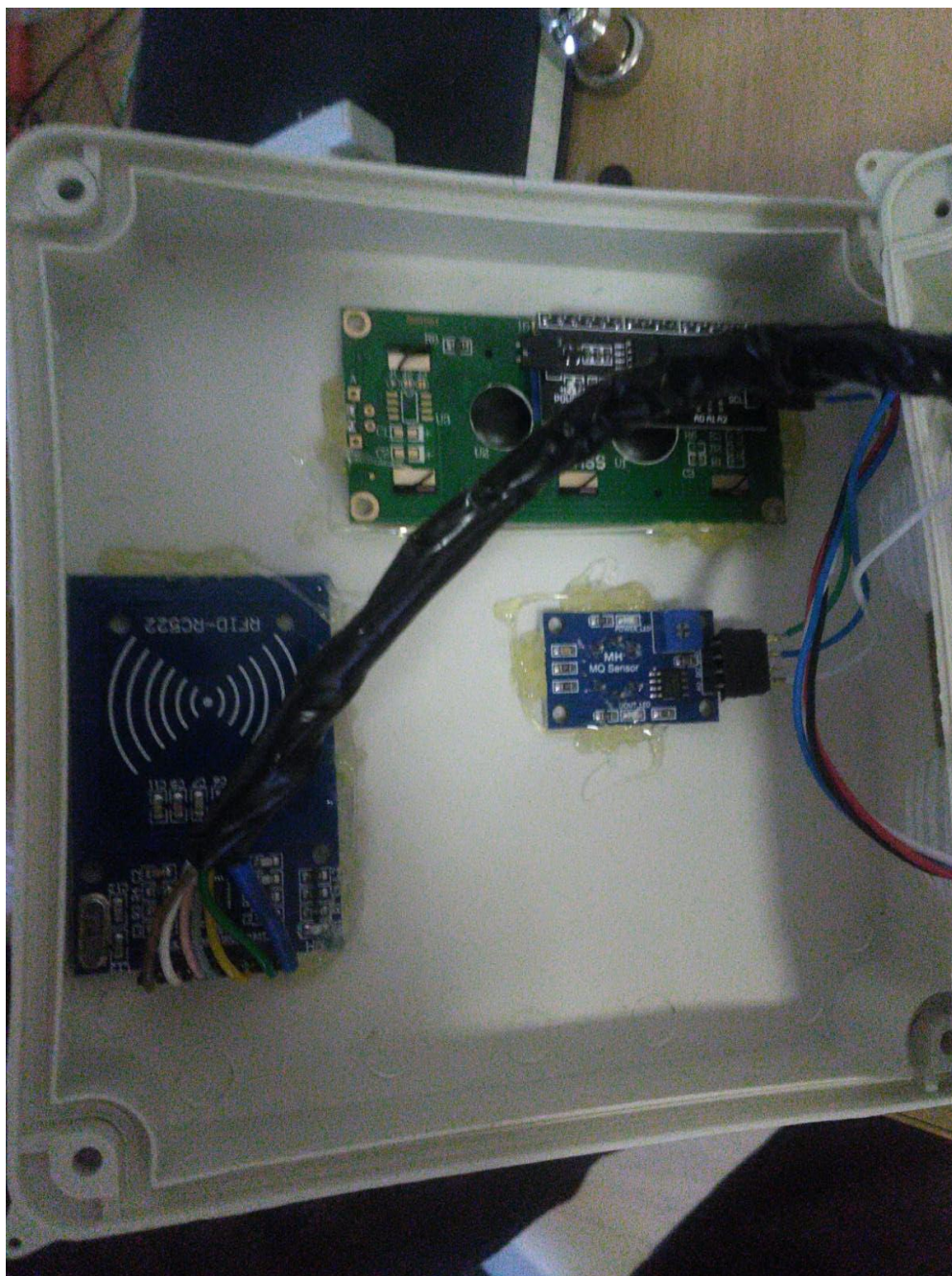
Рисунок 2.11 – Кріплення елементів на кришку корпусу
