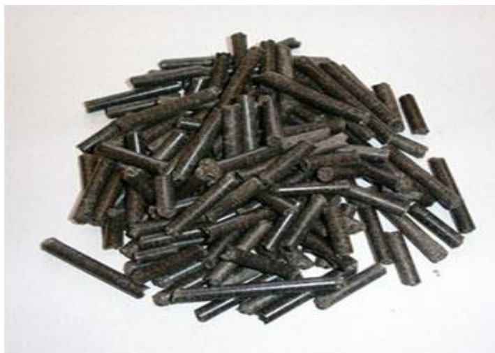
Рисунок 1.1 – Паливні гранули (пелети) з лузги соняшника
