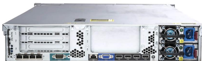
Рисунок 3.2 –Роз'єми серверу hp proliant dl380p gen8
