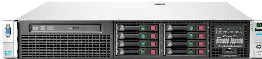
Рисунок 3.1 – Передня панель з корзинами серверу hp proliant dl380p gen8
