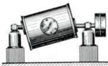
Рисунок 3.1 - Змішувачів зі зміщеною віссю обертання
