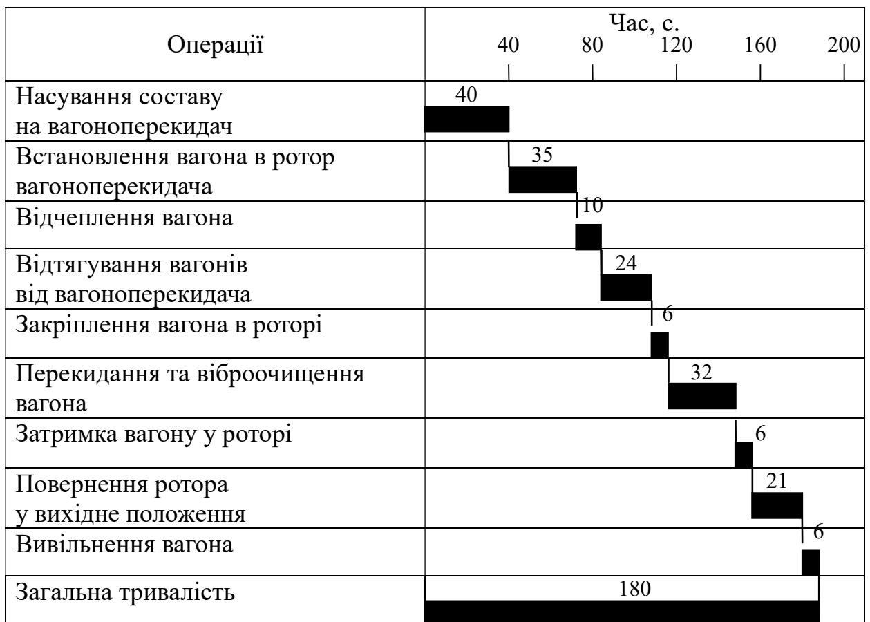
Рисунок 2.3 – Цикл роботи вагоноперекидача при розвантаженні вагона з вугільним концентратом за існуючим варіантом
