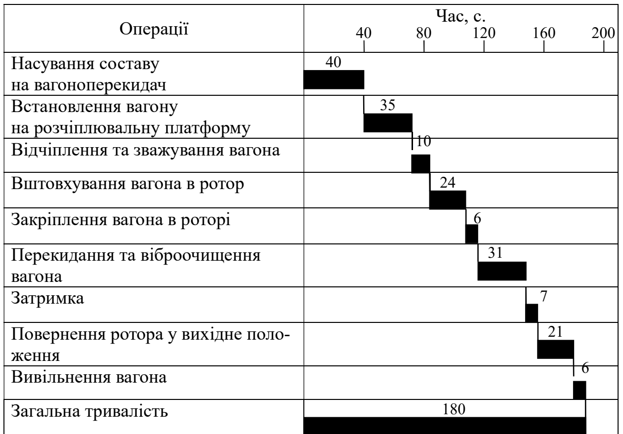
Рисунок 2.4 – Цикл роботи вагоноперекидача при розвантаженні вагона з вугільним концентратом за пропонованим варіантом
