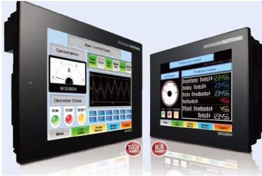
Рисунок 3.12 – Сенсорні панелі оператора для керування технологічними процесами
