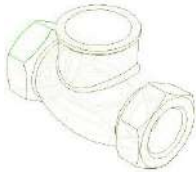
Рисунок 7.19 – Режим відображення деталі «Невидимые линии тонкие»
