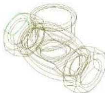
Рисунок 7.17 – Використання типу відображення «Каркас» при роботі зі складною моделлю
