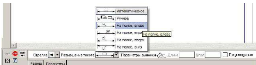
Рисунок 10.18 – Вибір параметрів простановки розмірів
