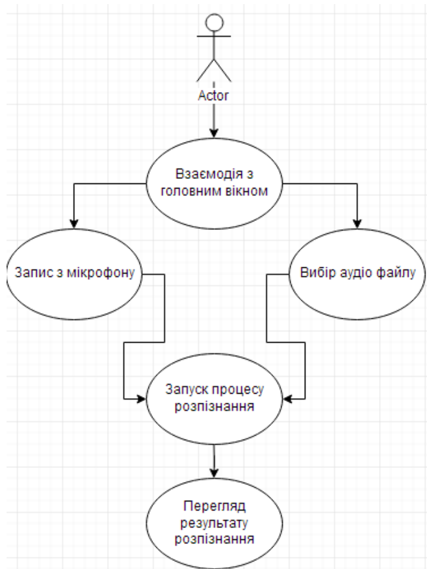
Рисунок 3.3 – Діаграма прецедентів програмного забезпечення для підтримки процесу розпізнавання звукових образів
