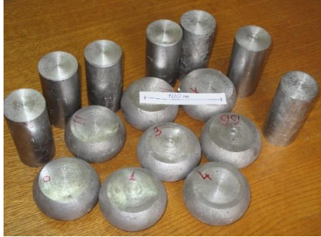
Рисунок 3 – Вихідні та осаджені циліндри для якісного визначення вмісту неметалевих включень у литому металі
