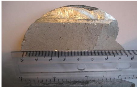
Рисунок 4 – Неметалеві включення на зломі проби Добаткіна
