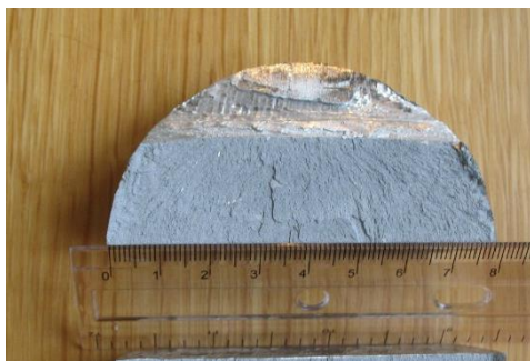
Рисунок 5 – Злом проби Добаткіна металу без неметалевих включень, відлитого після фільтрування
