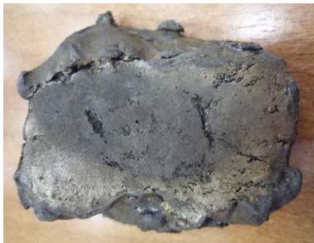
Рисунок 1.3 - Поверхня футерування зі сталі Гадфільда після експлуатації в кульовому млині
