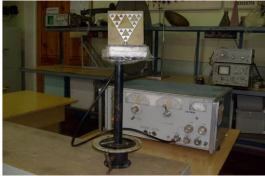
Рис. 5.2 - Передавальна частина - антена і генератор Г4-76А
