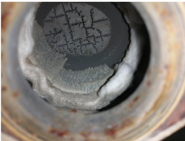
Рисунок 4 – Пошкодження каталізатора автомобіля Hyundai Grandeur
