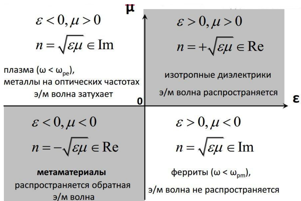
Рисунок 2.1 – Класифікація фізичних середовищ в залежності від значення діелектричної ( \epsilon ), і магнітної ( \mu ) проникності, і характеру їх впливу на електромагнітну хвилю
