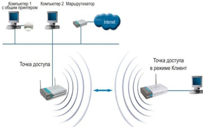
Рисунок 1.4 – Бездротова мережа з точкою доступу в режимі клієнта
