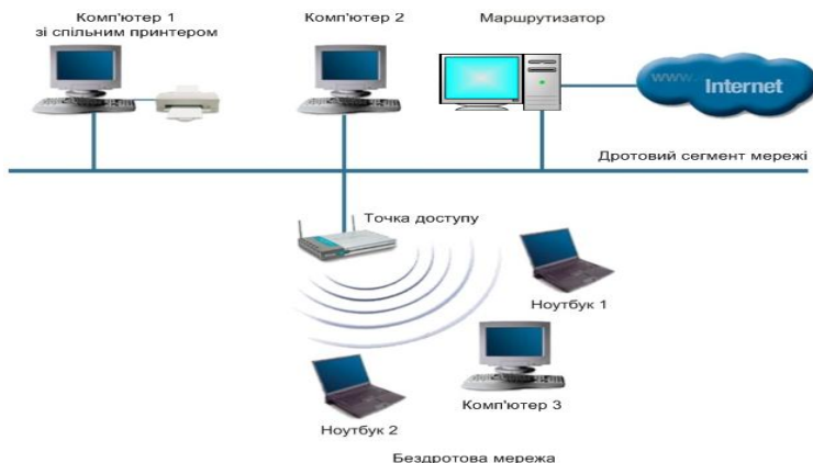
Рисунок 3.1 – Бездротова мережа з точкою доступу, підключена до дротової мережі
