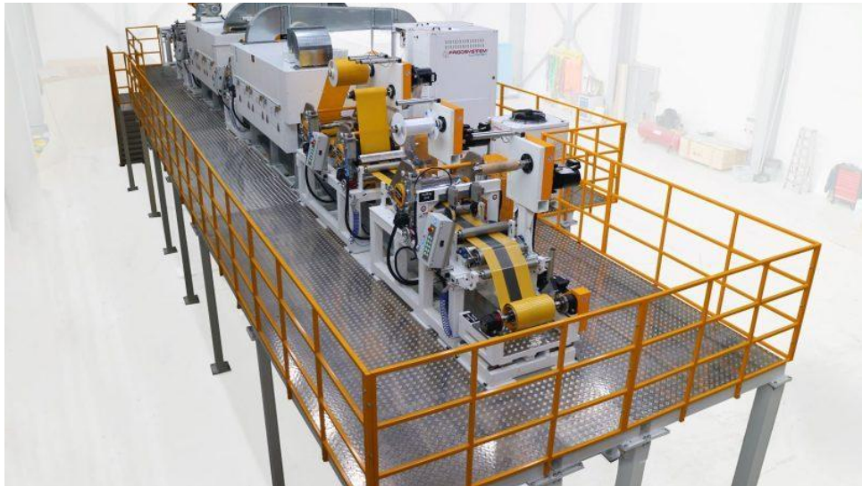
Рисунок 1.1 - Модульна лінія просочування для виробництва тканинних і препрегів, а також джгутових препрегів
