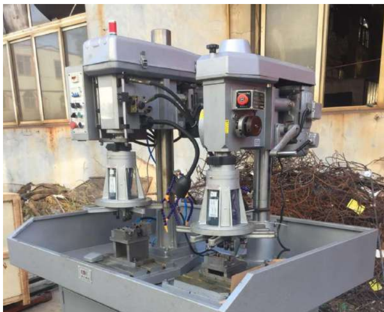
а – загальний вигляд, б – встановленої на верстаті Рисунок 4.18 – Приклад багатшпindelної верстатної головки
