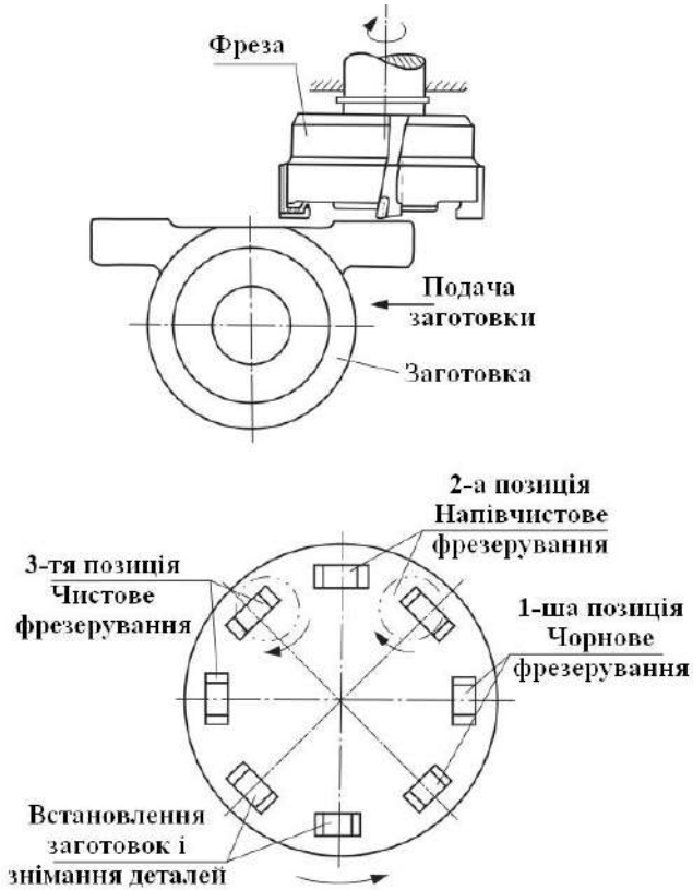
Рисунок 5.4 – Фрезерування корпусів підшипників на чотирипозиційному карусельно–фрезерному верстаті
