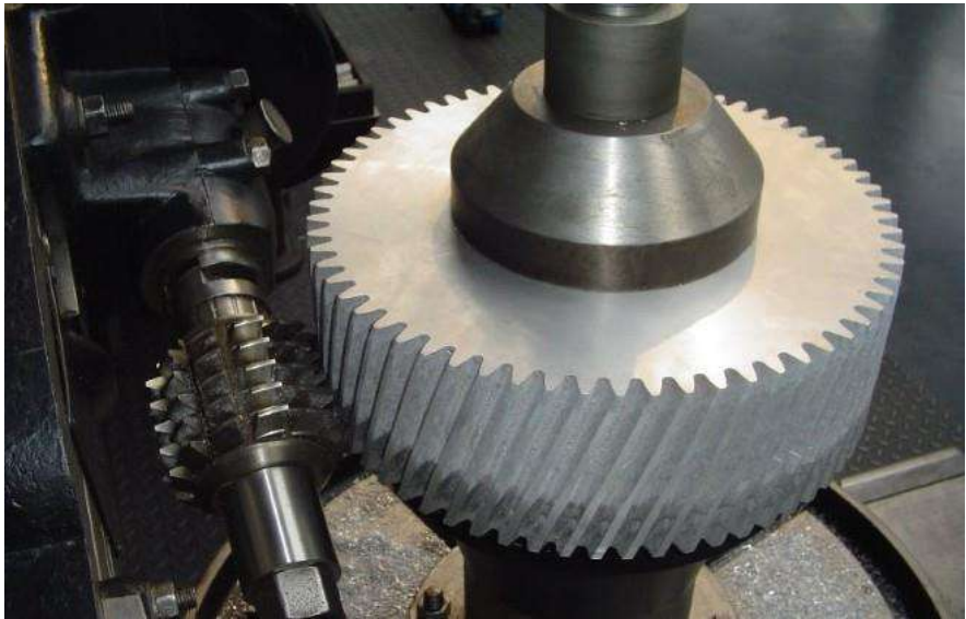
Рисунок 4.22 – Процес шевінгування зубчастого колеса: зіскоблювання стружки шевером з бічних поверхонь зубів
