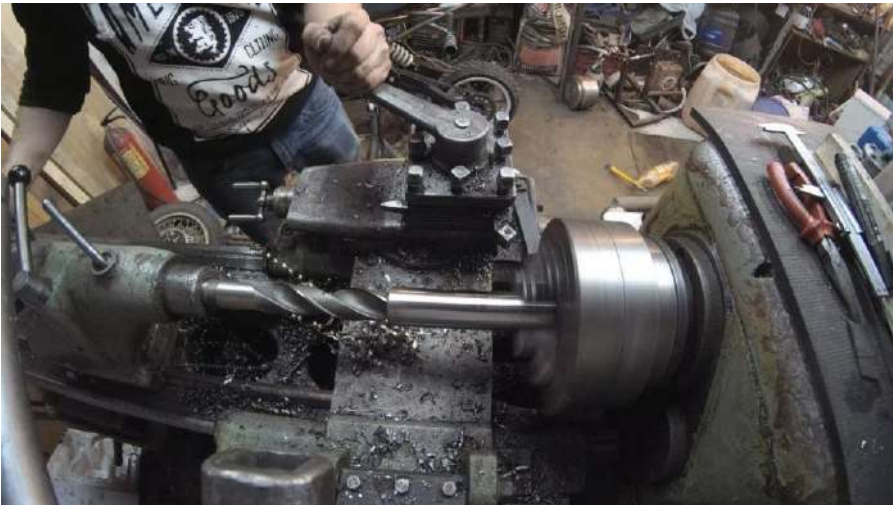
Рисунок 4.17 – Процес свердління отвору в деталі на токарному верстаті
