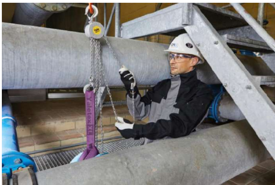
Рисунок 2.29 – Використання ручної ланцюгової талі YaleMINI 360
