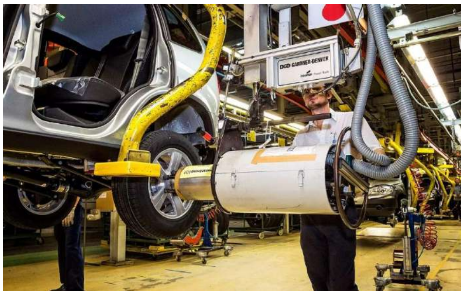
Рисунок 2.14 – Приклад автоматизації робочого місця на конвеєрі автозаводу (пост установки коліс)
