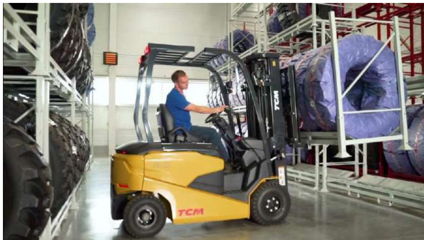
Рисунок 2.25 – Навантажувач вилковий TCM (Японія) 1.8т, з висотою підйому до 7 метрів
