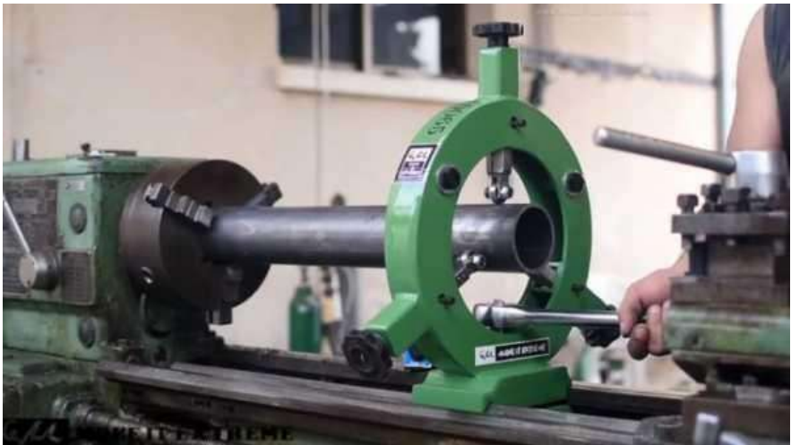
Рисунок 4.4 – Люнет для токарного верстата (люнет це основна опора при обробці на токарному або шліфувальному верстаті)
