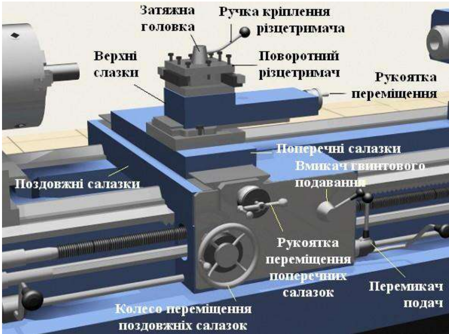
Рисунок 4.13 – Супорт токарного верстата
