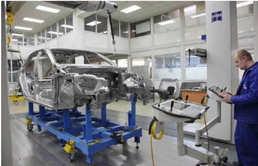
Рисунок 2.5 – Пост контролю геометрії кузова автомобіля автозаводу ЗАЗ, як приклад стаціонарного робочого місця
