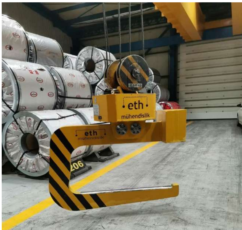
Рисунок 2.26 – Захват для переносу сталевго листа в рулонах
