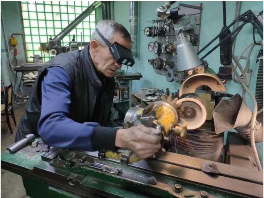
Рисунок 2.19 – Процес заточування різального інструменту
