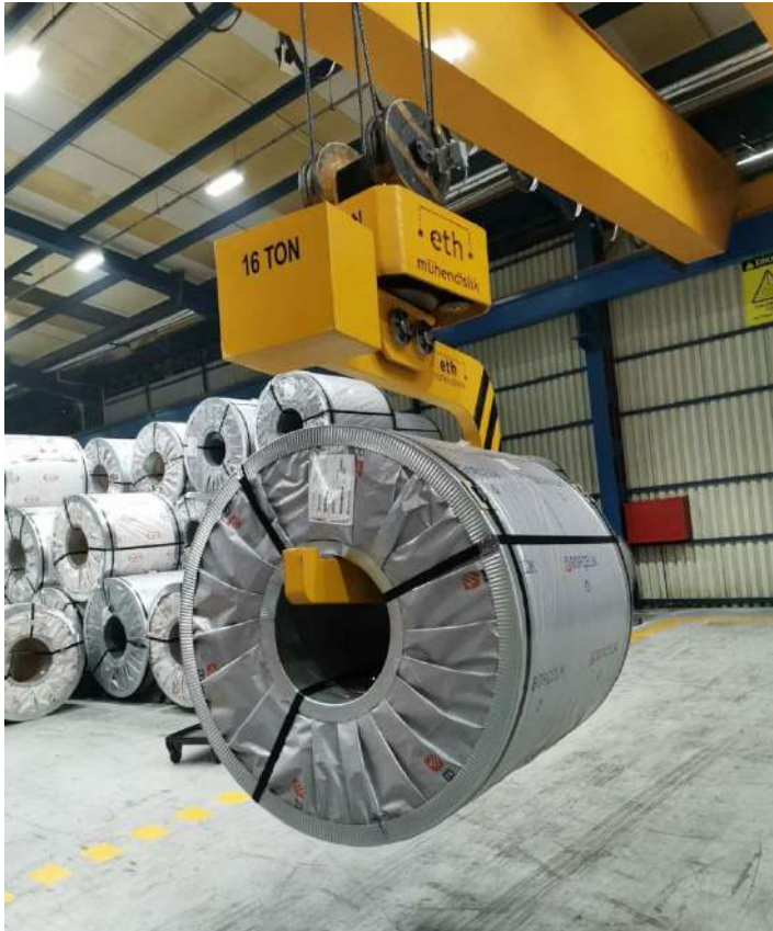
Рисунок 2.27 – Процес переносу захватом рулона сталі в цеху
