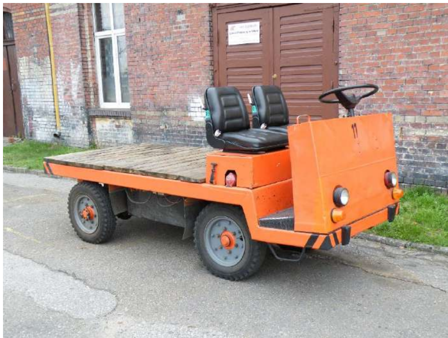
Рисунок 2.24 – Платформенний електровізок (розмов. «електрокара») Balkancar EP 006 (вантажопідйомність 2 тонни) є типовим представником внутрішньоцехового транспорту
