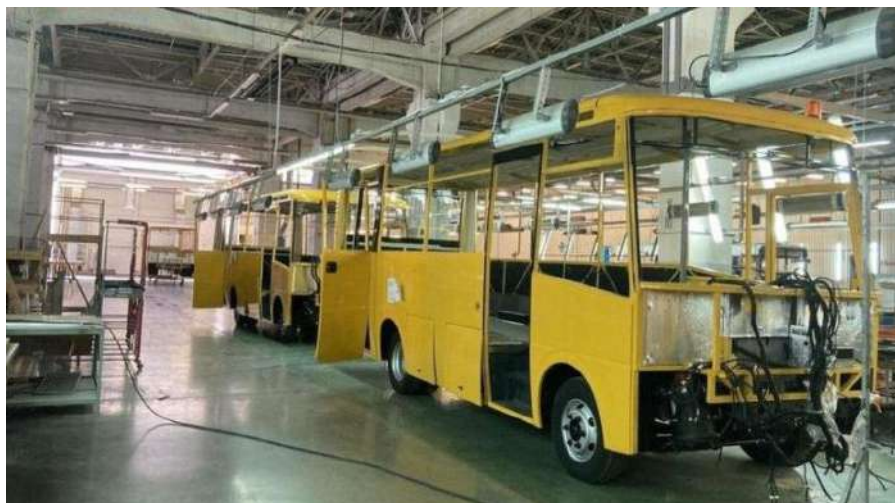
Рисунок 2.2 – Виробництво автобусів А08 на ПАТ «ЗАЗ»
