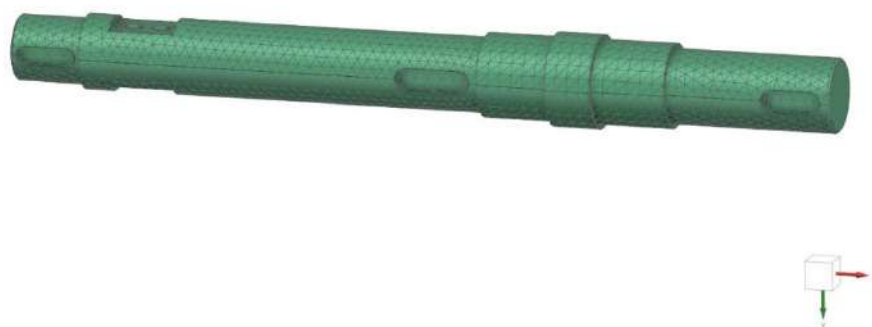
Рисунок 2.6 – Розбивка валу коробки змінних передач сіткою кінцевих елементів
