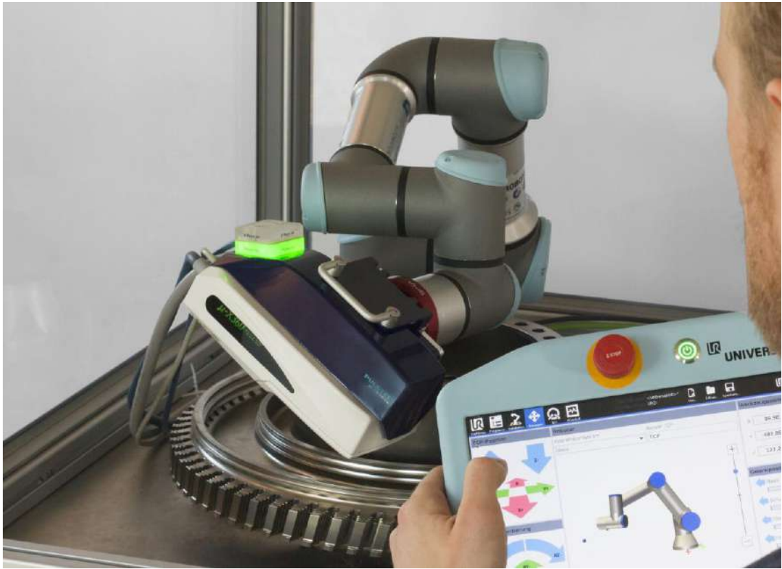
Рисунок 4.4 – Вимірювання на диску турбіни за допомогою коллаборативного робота [12]
