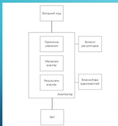
Рисунок 4 - Проміжний вигляд структури аналізатора коду
