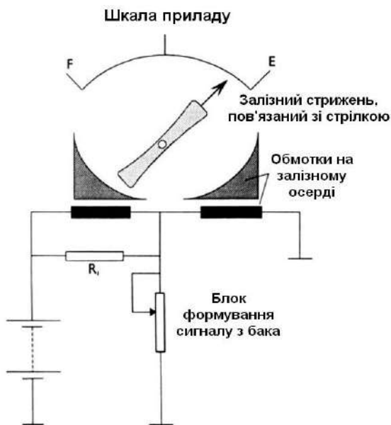
Рисунок 12.5 – Схема і принцип дії приладу з переміщенням залізного елемента
