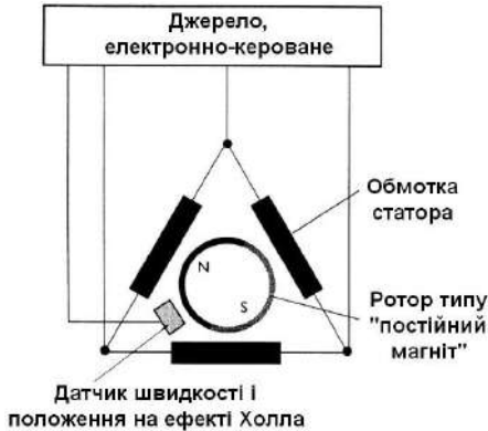
Рисунок 15.4 – ЕС-мотор посередині між моторами змінного і постійного струму
