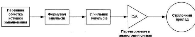
Рисунок 12.8 – Блок-схема тахометра, який використовує сигнали від котушки запалювання
