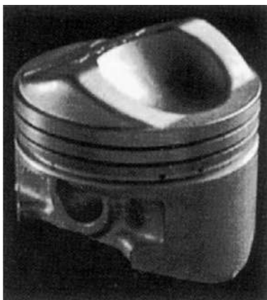
Рисунок 7.27 – Оптимальна форма вершини поршня
