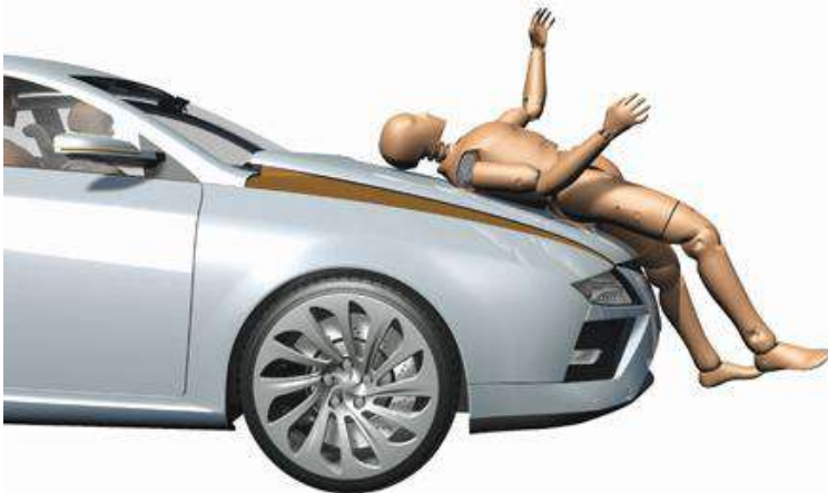
Рисунок 10.19 – Активний капот системи захисту пішоходів
