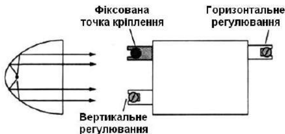
Рисунок 9.12 – Принцип регулювання напрямку світла фари
