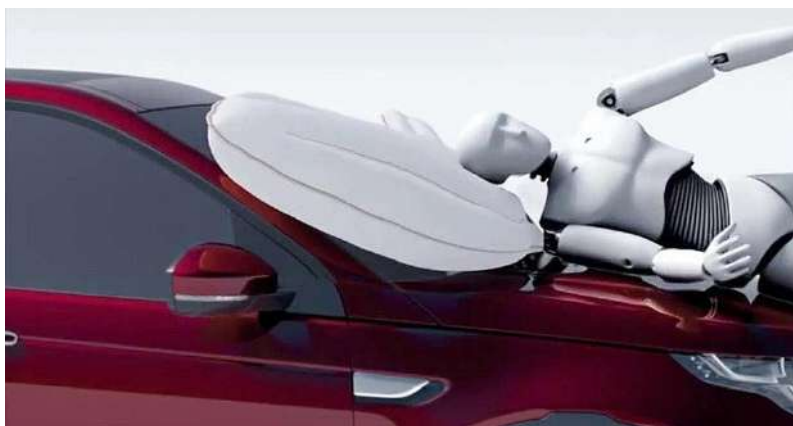
Рисунок 10.20 – Активний капот з подушкою захисту пішоходів
