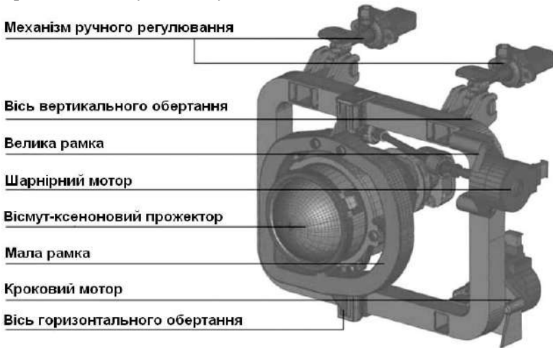
Рисунок 9.29 – Механічна конструкція системи ASF
