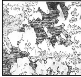
а – сплав ФТі30А, алюмотермічного способу виробництва; б – сплав ФТШ45. Рисунок 1 – Мікроструктура сплавів феротитану \times 300
