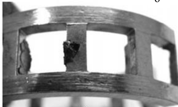
а - нашарування матеріалу роликів на поперечних перемичках; б - заклинення роликів; в - кільцеві риси і вм'ятини на повздовжніх перемичках
