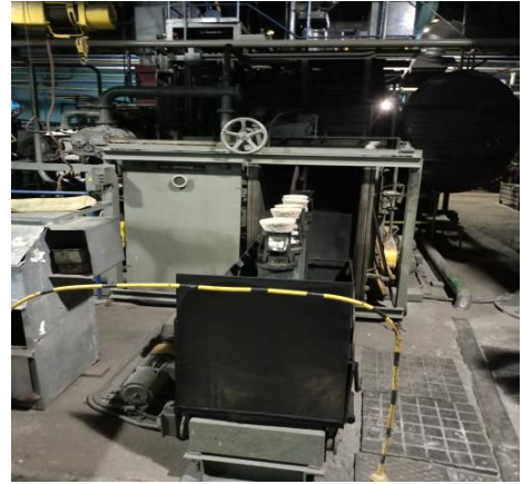
Рисунок 2.1 – Металургійна вакуумна піч FM-1-2-100 фірми «ULVAC»
