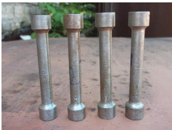
Рисунок 4.6 – Заварені зразки після для механічні випробувань.
