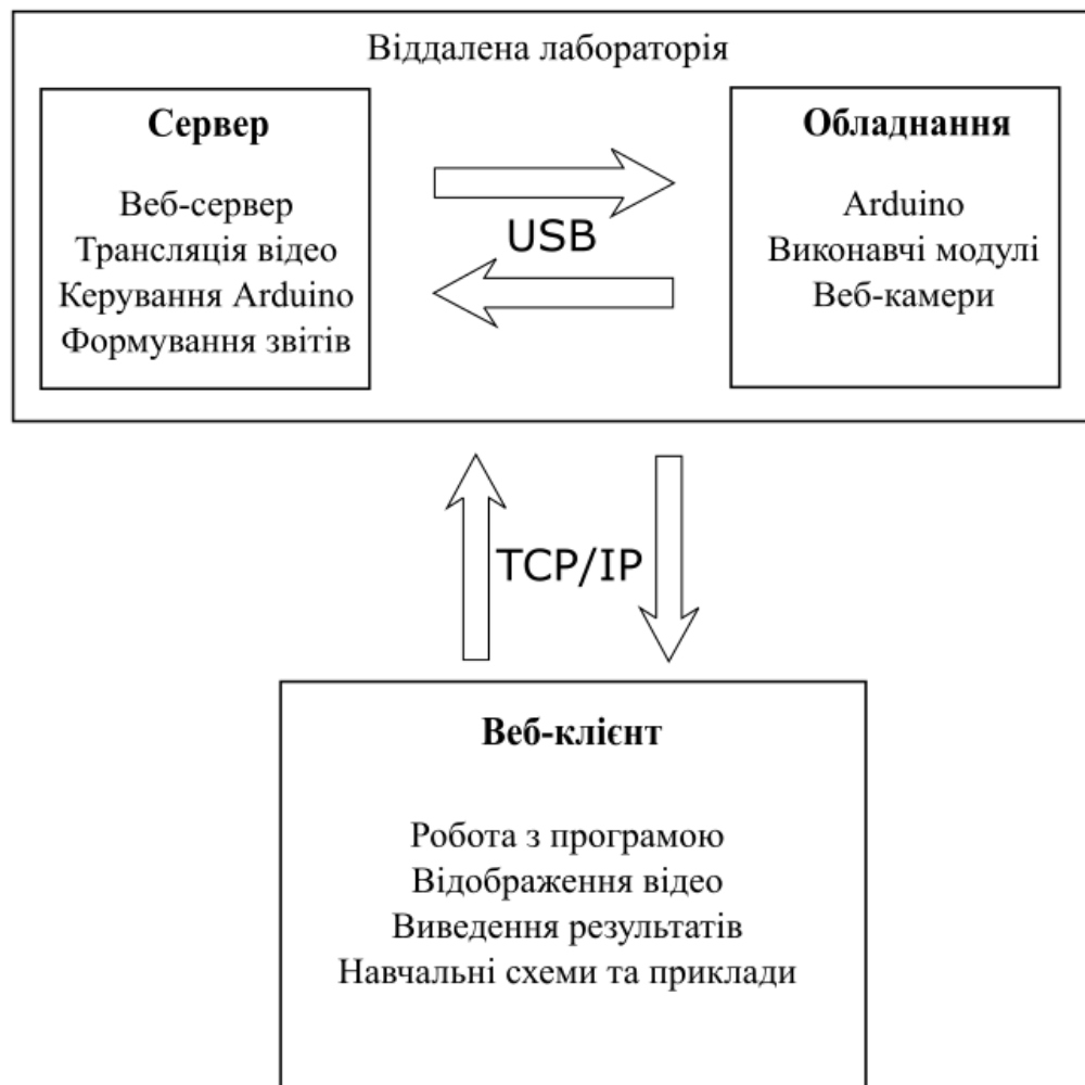
Рисунок 1.8 – Архітектура віддаленої лабораторії RELDES
