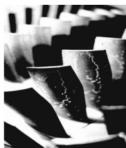
Рисунок 5.1 - Титанові лопатки компресора ГТД з сольовим відкладенням [17]
