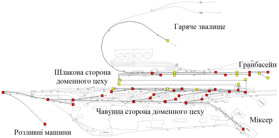
Рисунок 2.2 – Топология транспортной сети модели МЛС перевозень рідкого доменного шлаку
