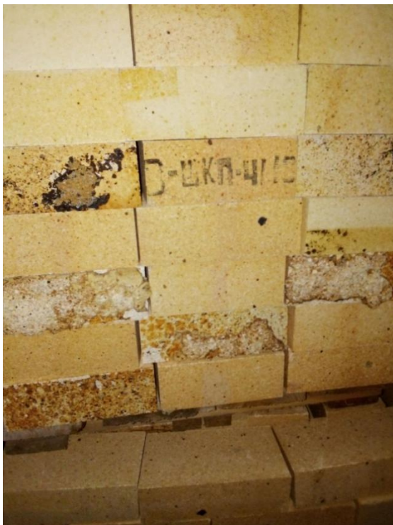
Рисунок 3.13- Налип на поверхні вогнетривкого виробу
