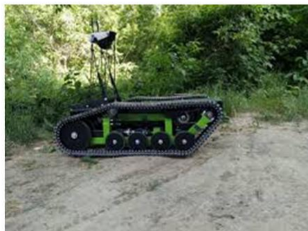
Наземний дрон розвідник-розмінер
