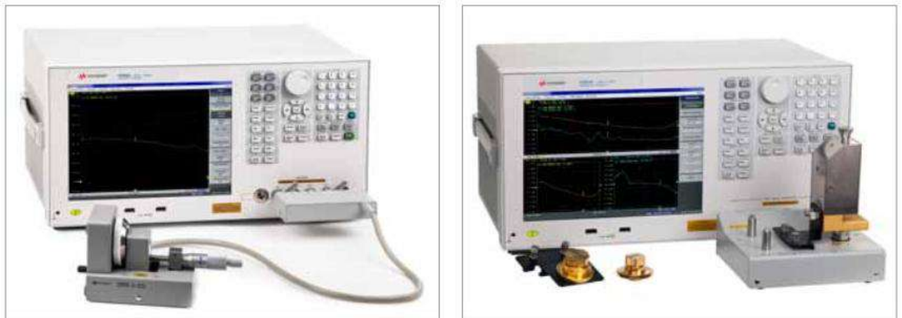
Рисунок 2.12 – Приклади оснащення (тестове оснащення) для вимірювання характеристик діелектриків з аналізатором імпедансу
