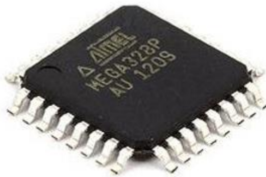
Рисунок 2.1 – Зовнішній вигляд мікроконтролера ATmega328p
