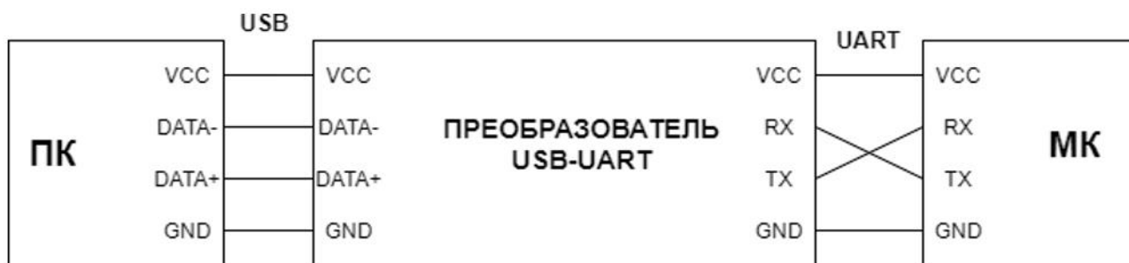
Рисунок 2.16 – Схема підключення пристроїв із живленням мікроконтролера
