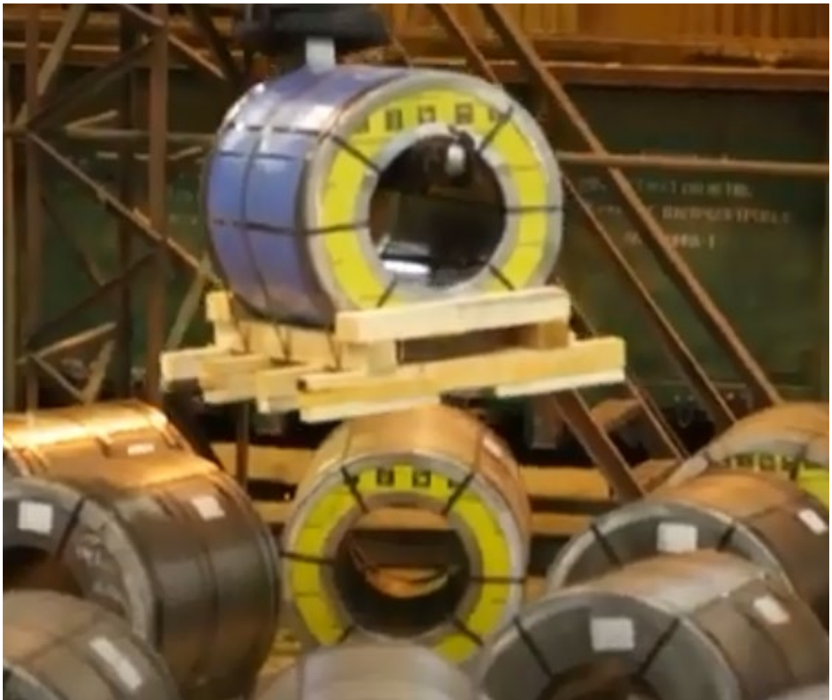
Рисунок 1.9 – Переміщення за допомогою скоби металопрокату у рулонах на дерев'яному піддоні
